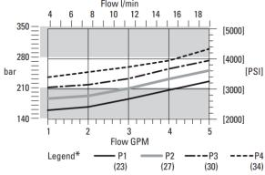
Figure 33 Cylinder Relief Valve
